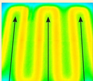
L'adhésif standard pour carrelage montre les points froids entre les fils
